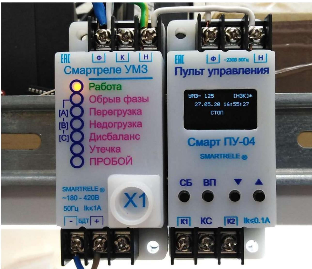
Рисунок 2 – подключение пульта Смарт ПУ-04 к приборам серии Смартреле
